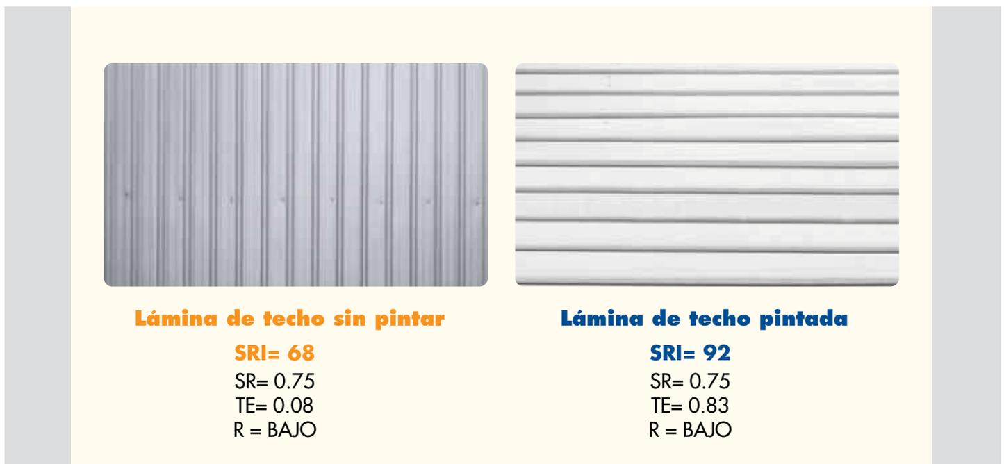
Partiendo de lo anterior, a continuación, se demuestra con cálculos matemáticos la diferencia entre aislar un techo con PRODEX y un techo con pintura convencional (con máximo valor SRI).
