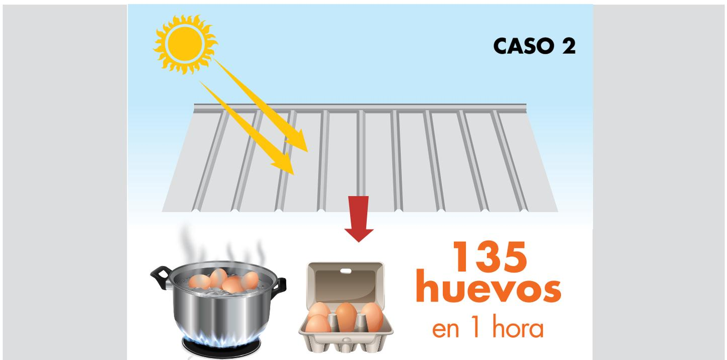
**Conclusión caso 2:** La pintura con (Índice de reflexión solar) SRI=100 (la mejor), reduce el paso del calor, pero no aporta un dato significativo de resistencia térmica, por ende, no sustituye la necesidad de instalar un aislante térmico en techos o paredes. Estos datos suponen que la pintura tiene un mantenimiento constante, que no está sucia por el paso del tiempo y que no está dañada por los rayos ultravioleta.
