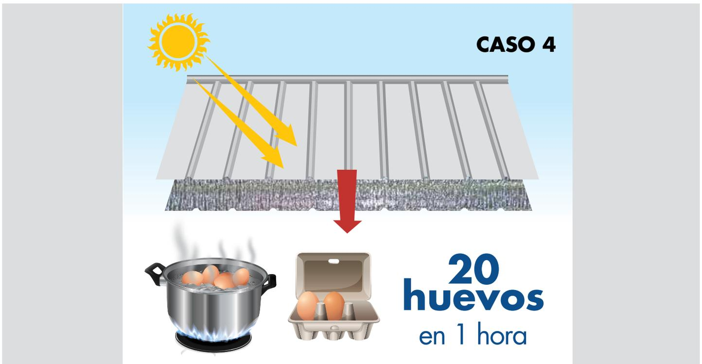
**Conclusión caso 4:** ambas tecnologías pueden trabajar en combinación, el uso de un aislante térmico y una pintura que mantiene el techo “frío” (con su correcto mantenimiento), reduce de manera significativa el ingreso del calor a través del techo.
